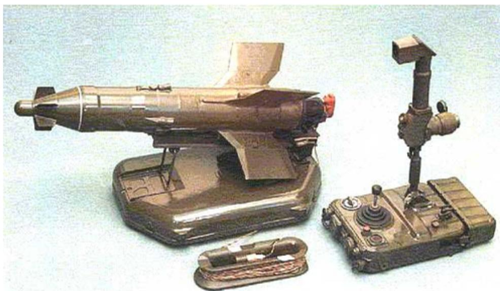
Изображенная на рисунке 15 противотанковая ракета «Малютка – 2» имеет вес боевой части вместе с корпусом, взрывателем и т.д. – 3,5 кг и пробивает броню толщиной 80 см.
